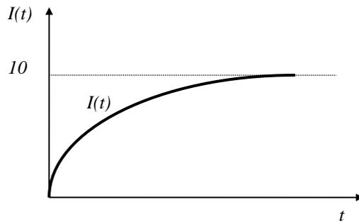
Ahora, consideraremos un circuito eléctrico formado por una batería o generador  $E$  [voltios], conectado en serie con una resistencia  $R$  [ohmio] y un condensador  $C$  [faradios].
