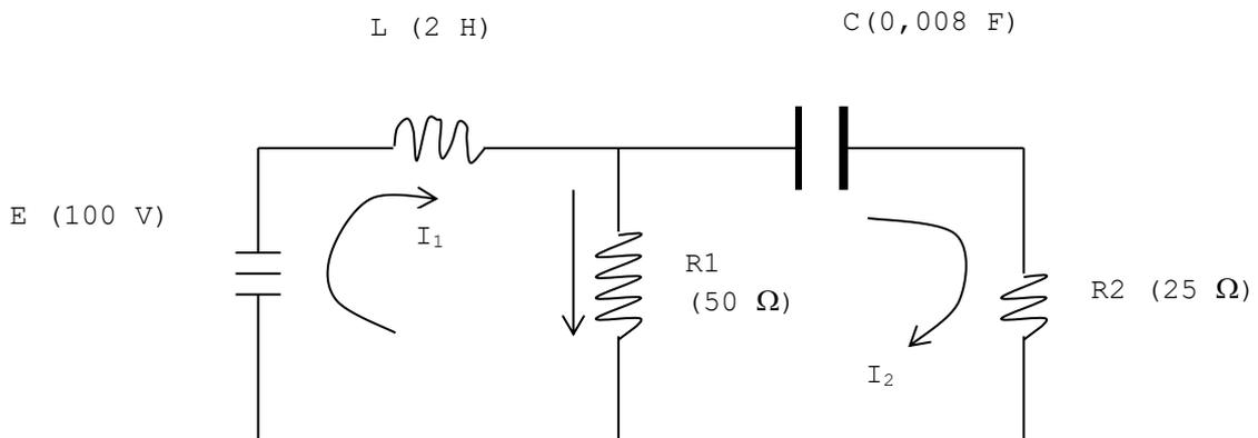
donde  $I_1(t)$  es la corriente que atraviesa a  $L$  e  $I_2(t)$  es la corriente que atraviesa a  $R_2$ . La corriente que pasa por la resistencia  $R_1$  es  $I = I_1 - I_2$ . Aplicando la ley de Kirchoff al circuito de la izquierda, queda:
