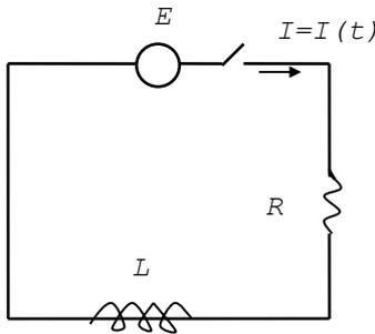
**Ejemplo:** Consideremos un circuito eléctrico formado por una fuente de voltaje  $E$  (batería o generador), una resistencia  $R$  y una inducción  $L$ , conectadas en serie. Según la Ley de Kirchoff, la fuerza electromotriz proporcionada ( $E$ ) es igual a la suma de la caída de voltaje en el inductor ( $L \, dI/dt$ ) y la caída de voltaje en la resistencia ( $R I$ ).
