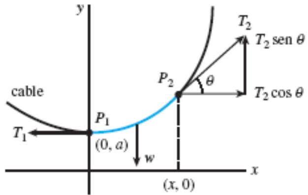
Hay 3 fuerzas actuando: el peso del segmento de cable  $P_1P_2$  y las tensiones  $T_1$  y  $T_2$ . Siendo  $w$  el peso por unidad de longitud del cable y  $s$  la longitud del segmento de cable, en equilibrio:
